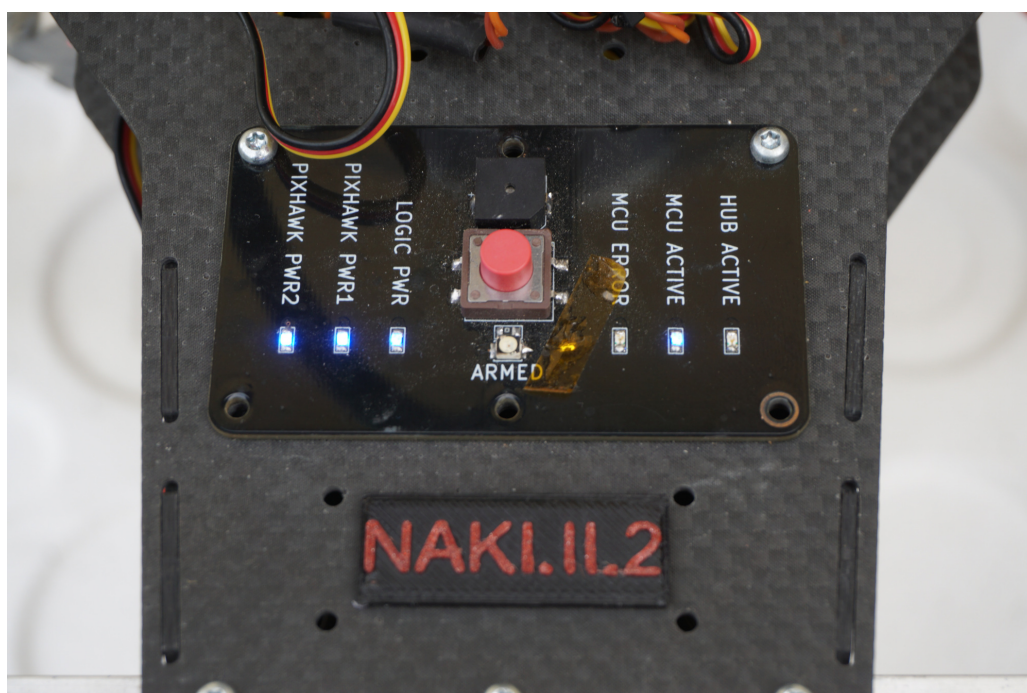
Obrázek 6: Diagnostická deska poskytující informace o funkci základní desky a napájení řídicích jednotek helikoptéry.
