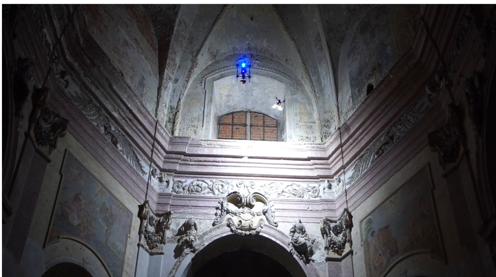
Obrázek 10: Navržený systém během nasazení ve špatných světelných podmínkách společně s druhou autonomní helikoptérou zajišťující osvětlení.
