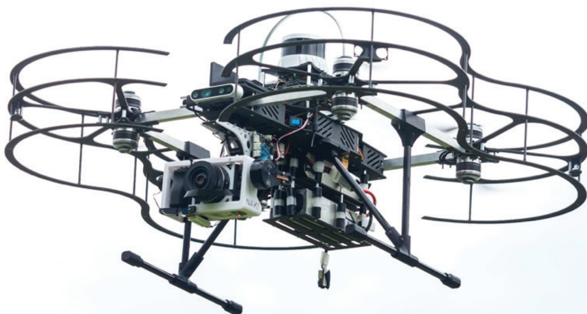
Obrázek 020: Bezpilotní vícerotorová helikoptéra navržena pro dokumentaci interiérů historických budov.
