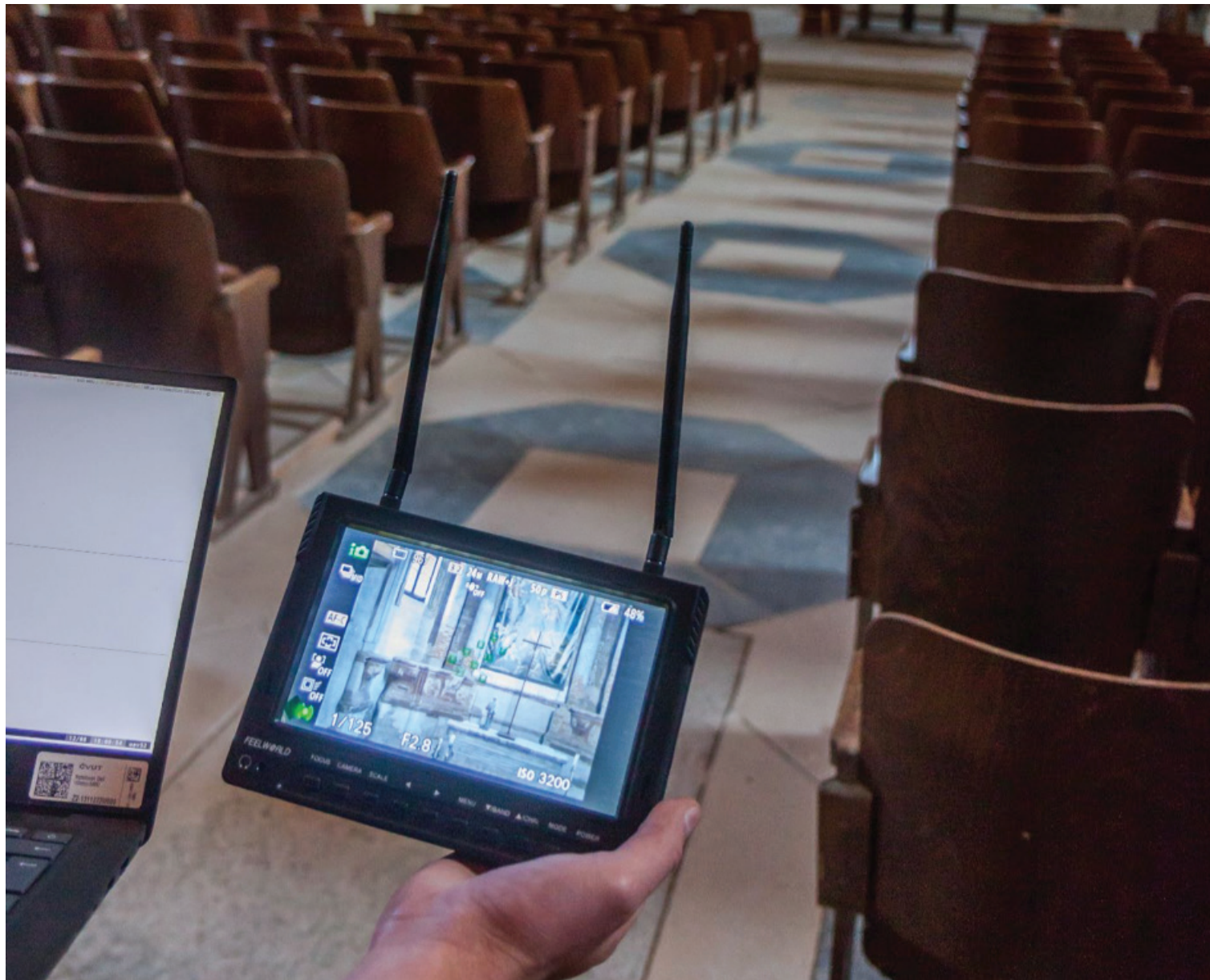
Obrázek 021: Obrázek z palubní kamery přenášený pomocí analogového vysílače na monitor operátora.
