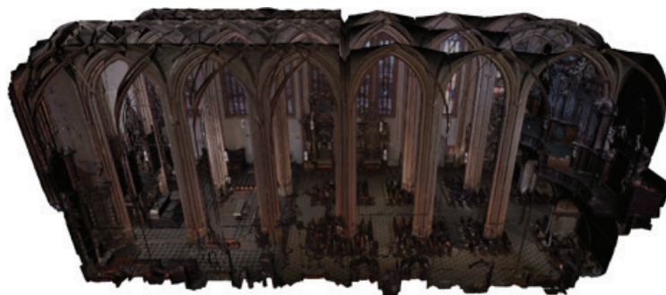
Obrázek 017: Ilustrace 3D reprezentací prostředí kostela sv. Mořice v Olomouci využívaných v rámci navržené metodiky - mračno bodů (vlevo) a 3D model s barevnou texturou (vpravo).
