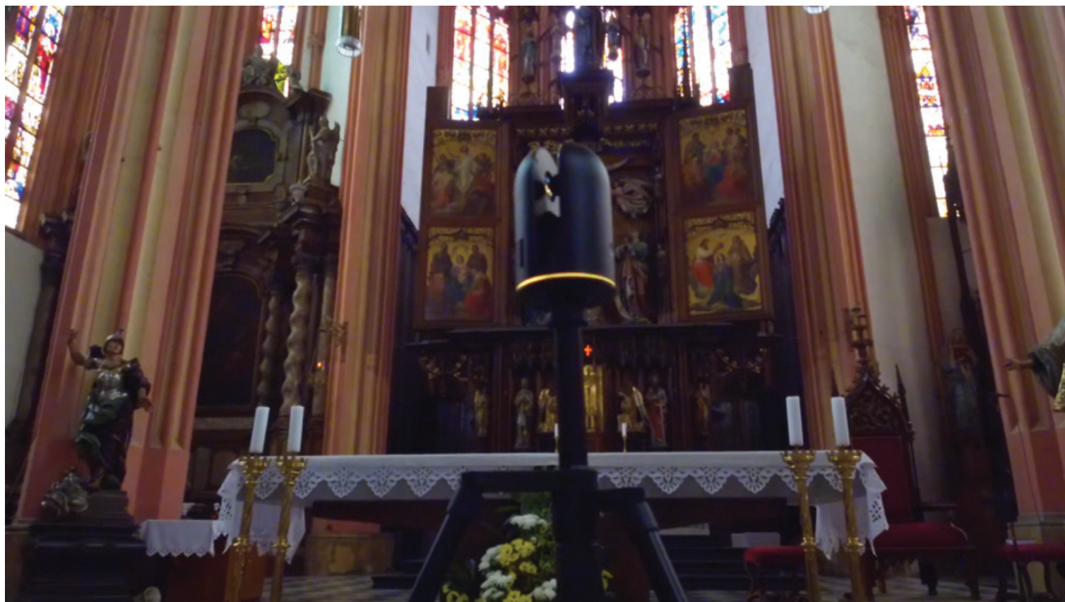
Obrázek 016: Skener Leica BLK 360 využití pro skenování interiéru kostel sv. Mořice v Olomouci.
